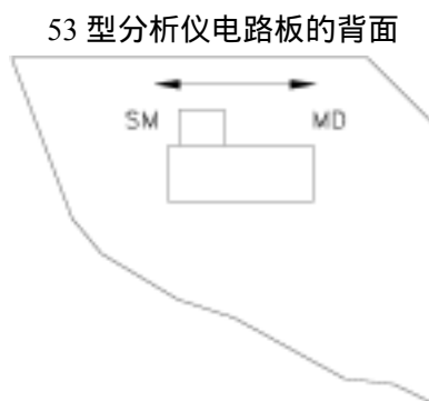
图 3-2 单分析仪模式/多分析仪模式开关位置 (仅用于装备有 HART 的分析仪)
